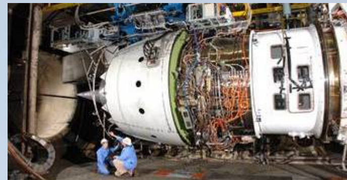
エンジン飛行性能の地上検証 AEDC エンジン高空性能試験設備 (米国: 世界最大)
