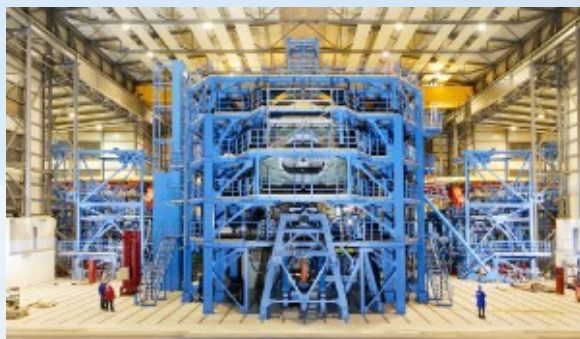
機体静強度試験・機体疲労試験 (A380独IABG)
